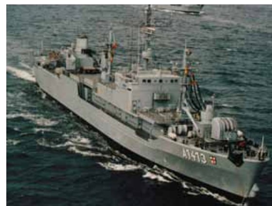
Die FREIBURG nach dem Umbau, erkennbar am großen Abstand von Schornstein und achterem Mast und dem Hubschrauberlandedeck
